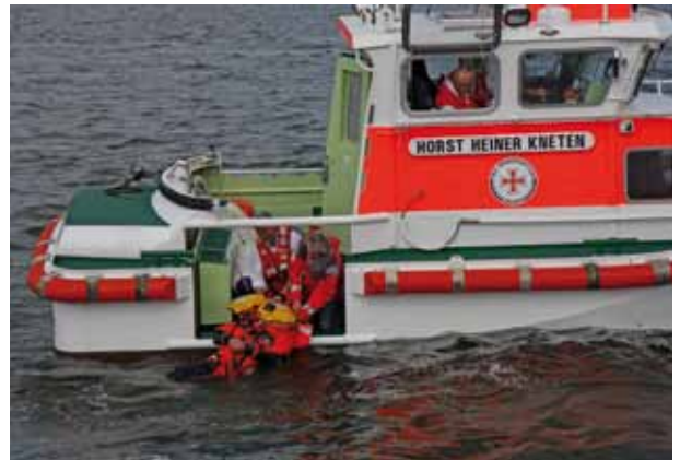
Seenotrettungsboot „Horst Heiner Kneten“ Übung: Rettung eines Schiffbrüchigen durch die Bergungspforte eines Seenotrettungsbootes.
